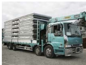
ユニットハウスの運搬風景
