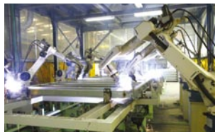
溶接ロボット
