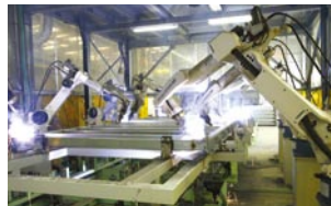
溶接ロボット
