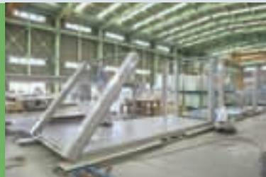
電気配線や内装を施した屋根、床、柱などを組立てます。
