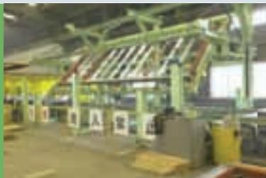
ロボットにより片側を溶接した後、自動で反転させ、反対側をさらに溶接します。
